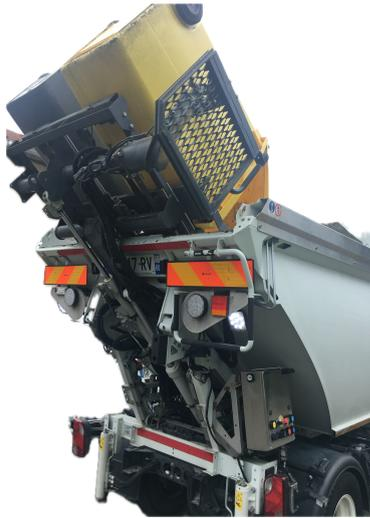
*Fig. 8 : Illustration d'une levée de conteneur sur une mini benne.*
