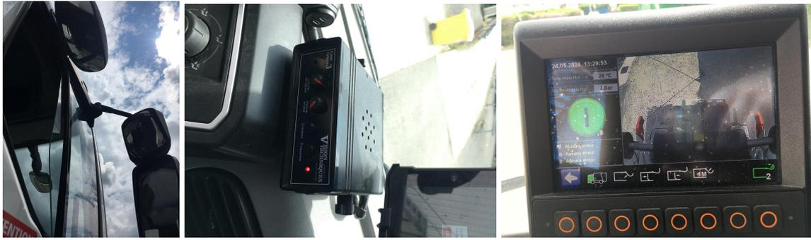
*Fig. 16, 17, 18 : Rétroviseurs, antévisseurs et écran de surveillance, permettant une vision périphérique des ripeurs et la communication avec eux, au chauffeur*
