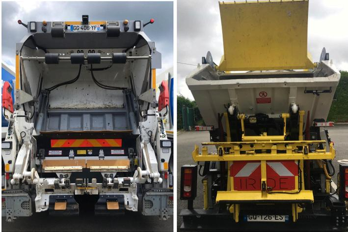
*Fig. 13 & 14 : Comparaison du camion benne (>19t) (à gauche) et d'une mini-benne (à droite). Leur structures propres imposent des gestes de collecte différents.*
