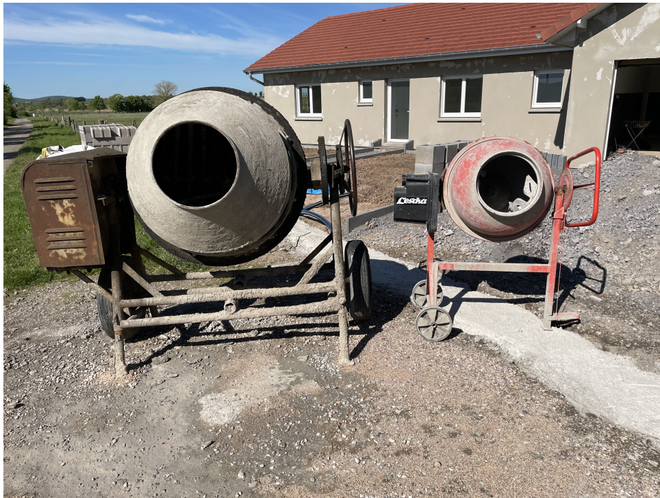
Figure 2.20. Bétonnière des années 1970 à gauche, bétonnière utilisées de nos jours en maçonnerie à droite
